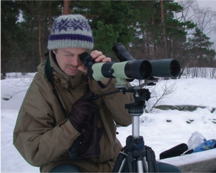
Testauksessa käytettiin erikoista jalustasysteemiä, jotta eri putkien rinnakkain vertaaminen olisi mahdollisimman helppoa. Kuvassa Nikon ja Swarovski
